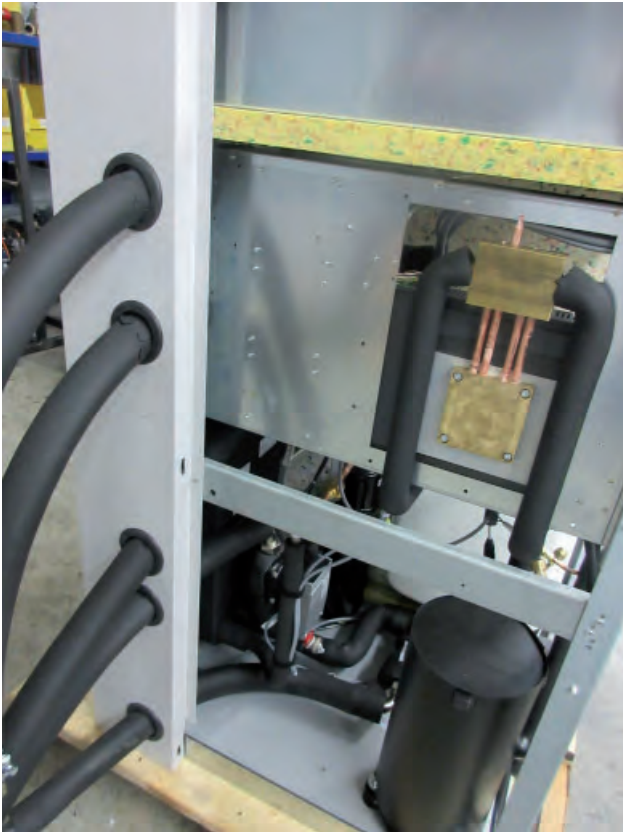
Fertig montierte Anschlussschläuche
