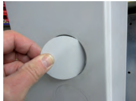
Perforierung an der Seite ausbrechen
