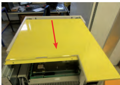
Abdeckblech nach vorne ziehen und abnehmen
