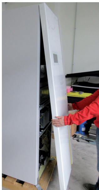
Mit Schraubenzieher die Verriegelung lösen
